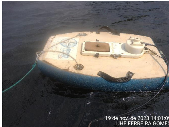
Figura 3 – Equipamento ADCP River Surveyor M9 Utilizado na Campanha.
