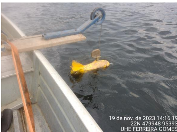
Figura 27 - Jusante – Coleta sólidos em suspensão.
