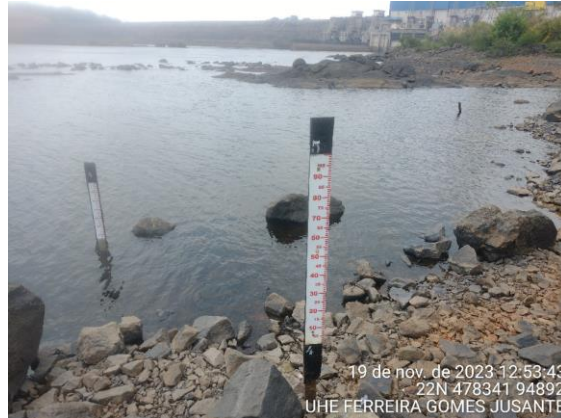
Figura 24 - Jusante – Lance de régua antes.
