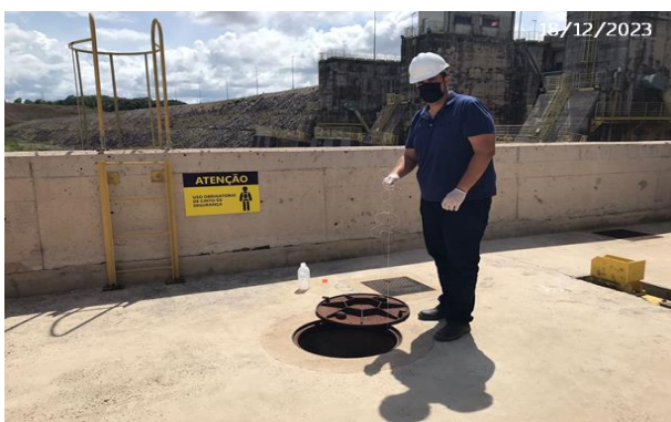
Coleta de efluentes na fossa séptica.
