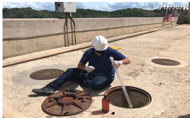
Coleta de efluentes na saída da caixa SAO.
