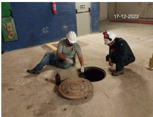
Coleta de efluentes na saída da caixa SAO.
