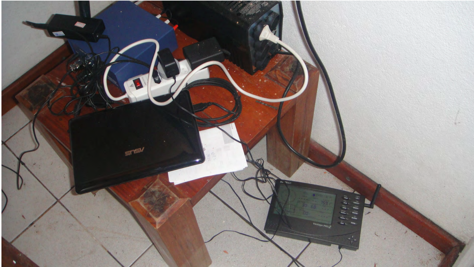
Foto 3 – Instalação dos equipamentos no interior do prédio, com a visão da estação meteorológica (unidade interna) e CPU.
