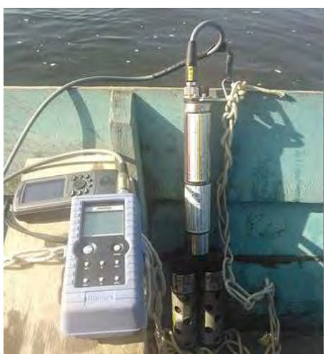
Figura 3a. Analisador de água Horiba modelo W23-XD utilizado para medição de parâmetros de qualidade da água em campo. Foto obtida em agosto de 2013.
