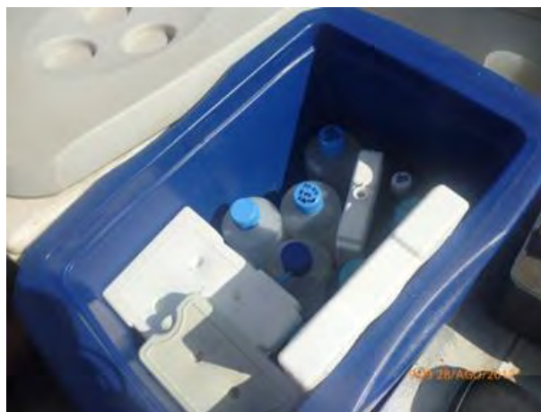
Figura 5. Acondicionamento dos frascos em gelo no recipiente para transporte das amostras aos laboratórios. Foto obtida em agosto de 2012.
