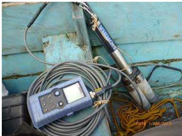
Figura 3a. Analisador de água Horiba modelo W23-XD utilizado para medição de parâmetros de qualidade da água em campo.
