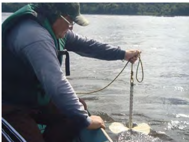
Figura 4. Disco de Secchi utilizado para determinação da transparência da água. Foto obtida em julho de 2013.
