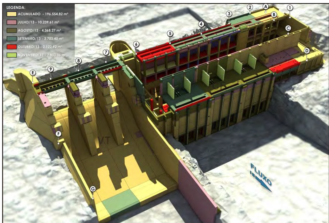
Figura 1.1 – Demonstrativo geral do andamento das edificações.
