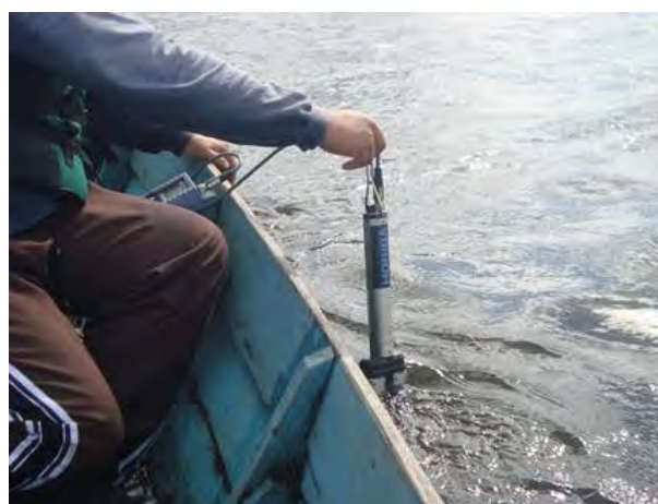
Figura 3b. Imersão do analisador para determinação de parâmetros de qualidade da água no local. Foto obtida em julho de 2013.
