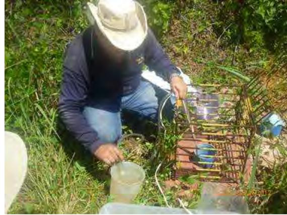
**Figura 30.** Coleta de amostras no poço de monitoramento (Pt14FG) a montante das obras de construção da barragem.
