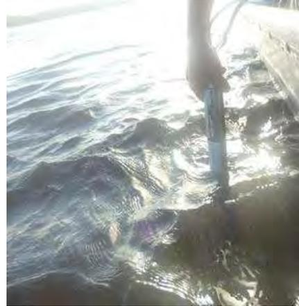
**Figura 3b.** Imersão do analisador para determinação de parâmetros de qualidade da água no local.
