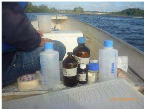
**Figura 6.** Variedade dos frascos utilizados para as coletas de amostras de água que foram enviadas ao laboratório.
