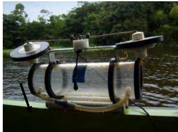
**Figura 5.** Garrafa de Van Dorn utilizada para as coletas de água superficial.
