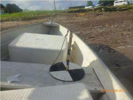
**Figura 4.** Disco de Secchi utilizado para determinação da transparência da água.
