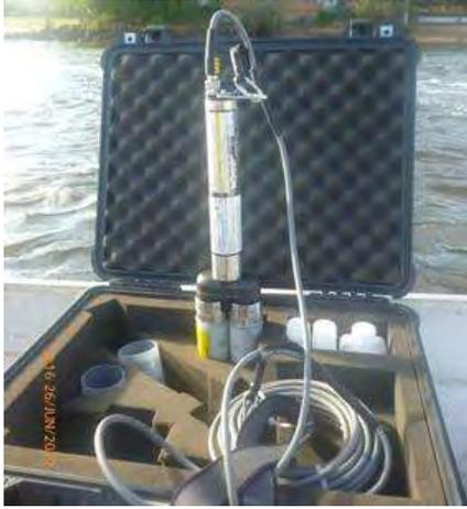
**Figura 3a.** Analisador de água Horiba modelo W23-XD utilizado para medição de parâmetros de qualidade da água em campo.
