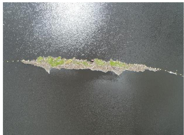
Imagem área do banco de taboa à deriva retido pelo *log boom* da UHE Ferreira Gomes.
