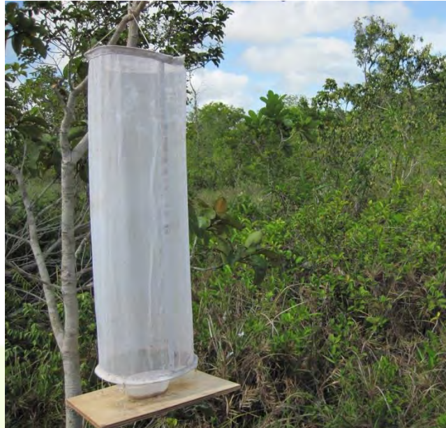
Figura 43 - Armadilha (Van Someren-Rydon) específica para a coleta de borboletas, com isca atrativa de banana fermentada na Área de Influência Direta do AHE-FG, Amapá.
