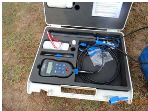
Figura 3. Analisador de água AG Solve modelo Aquameter 200 e Aquaprobe 2000 utilizado para medição de parâmetros de qualidade da água em campo. Foto obtida em novembro de 2013.
