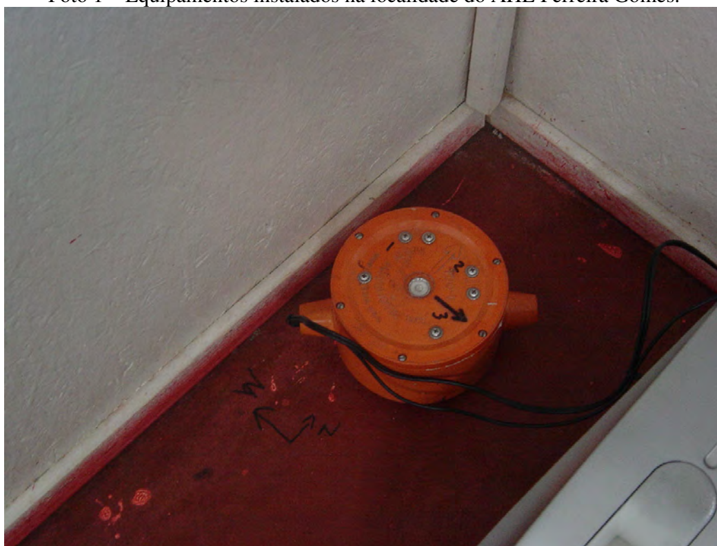
Foto 2 – Detalhe do sismômetro instalado na localidade do AHE Ferreira Gomes.
