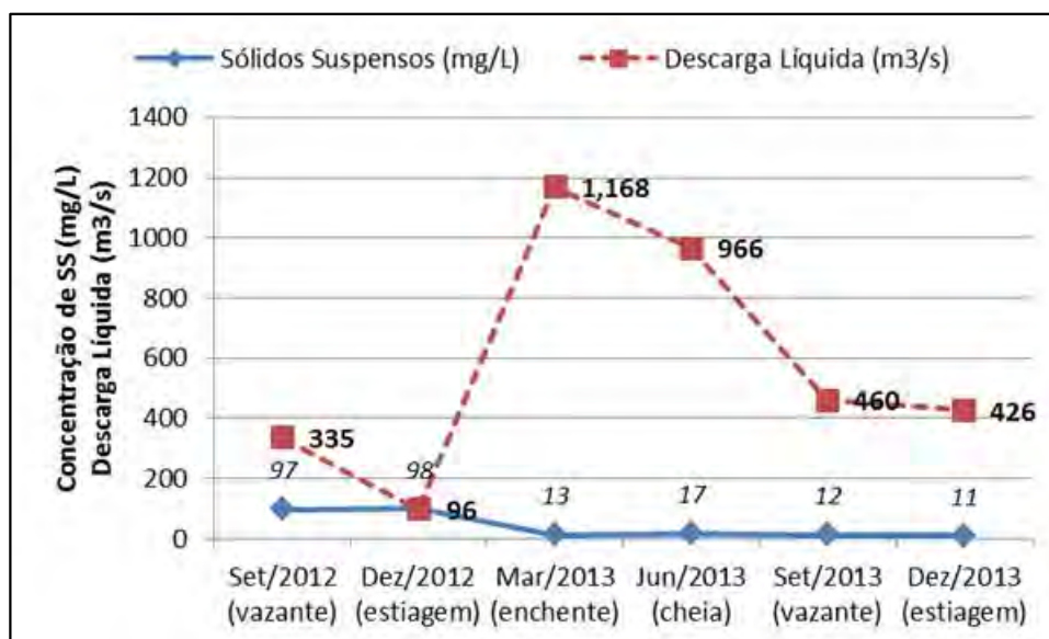
Figura 20. Gráfico da concentração de SS e descarga líquida em períodos hidrológicos distintos. Note que no ano de 2013 a concentração de sedimentos em suspensão diminuiu bruscamente no rio Araguari a montante do município de Cutias.
