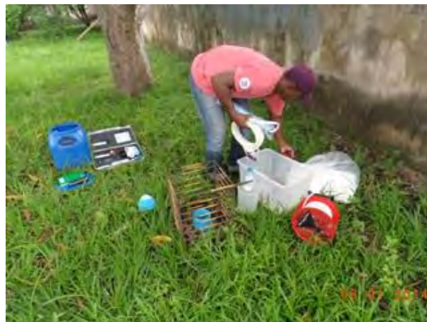
Figura 48. Poço de monitoramento (Pt15FG) localizado na cidade de Ferreira Gomes. Realização da medição do nível estático da água do poço..
