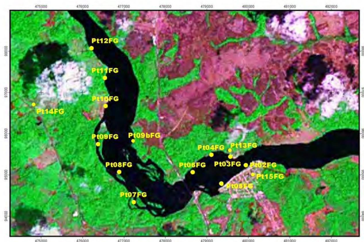
Figura 2. Área próxima a Ferreira Gomes mostrando os pontos de amostragem ao longo do rio Araguari para o monitoramento da qualidade da água. Para esta campanha realizada no dia 28 de janeiro de 2014 os pontos monitorados foram: Pt02FG; Pt04FG; Pt05FG; e o ponto a montante do ponto Pt07FG. Coordenadas de localização em UTM, Datum WGS84. Fonte: Imagem Landsat TM-7. Projeto Zulu, NASA, 2000.
