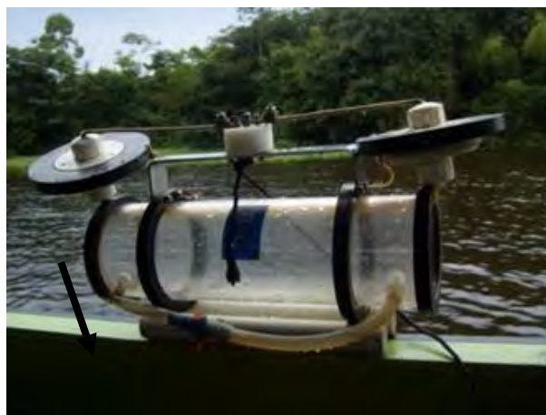
Figura 5. Garrafa de Van Dorn utilizada para as coletas de água superficial.
