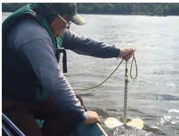
Figura 5. Disco de Secchi utilizado para determinação da transparência da água. Foto obtida em julho de 2013.
