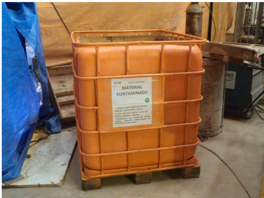
Figura 3.4.1.2 – Confeção de coletores com a reutilização de tanques de 1000L.
