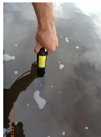
Figura 4. Imersão do analisador para determinação de parâmetros de qualidade da água no local. Foto obtida em novembro de 2013.
