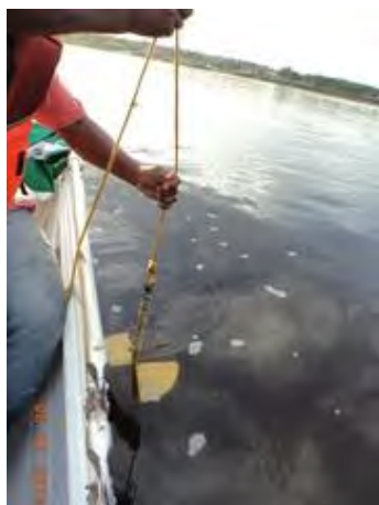
Figura 4. Disco de Secchi utilizado para determinação da transparência da água.
