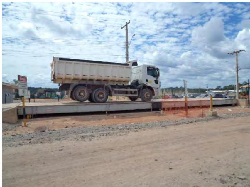
Figura 2.4.1 - Balança instalada na Portaria Principal.
