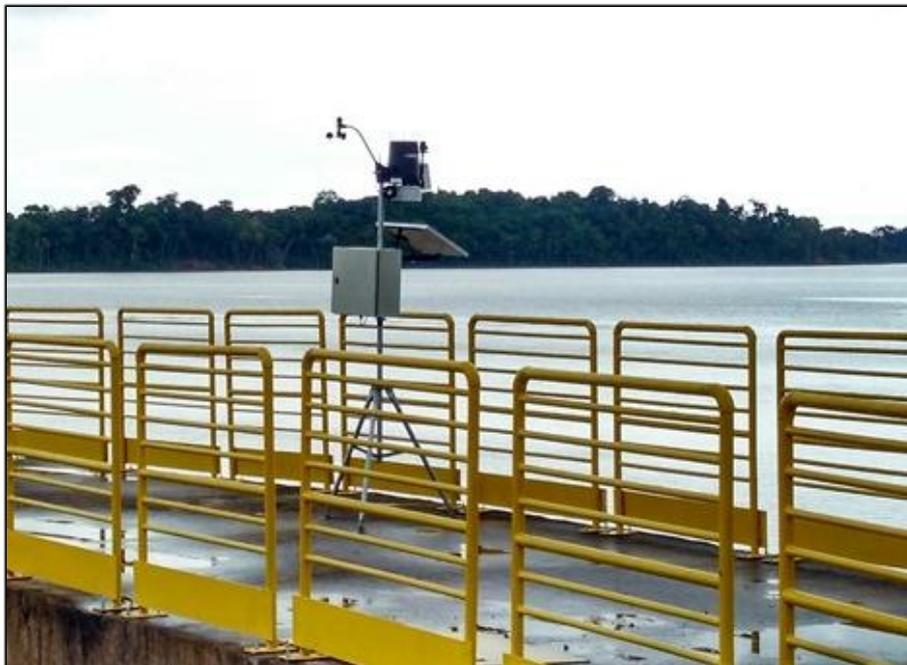
**Figura 4 – PCD instalada no barramento da UHE Ferreira Gomes.**
